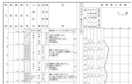
図-2 試験地のボーリング柱状図(諏訪)
